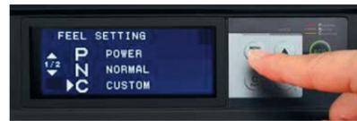
\*При заказе погрузчика внимательно изучите разницу между режимом P (Power) и режимом N (Normal) перед настройкой стандартного режима функционирования.
