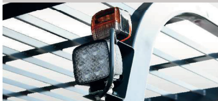
Светодиодные фонари в стандартной конфигурации, более энергосберегающие и яркие с длительным сроком службы
