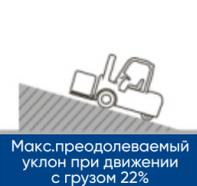
Макс. преодолеваемый уклон при движении с грузом 22%
