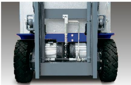
Привод передних колес от 2-х электродвигателей позволяет увеличить мощность
