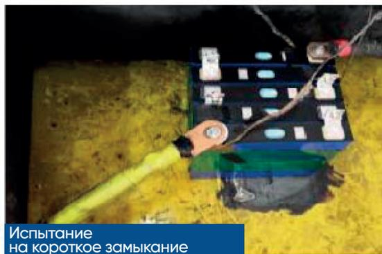
Испытание на короткое замыкание
