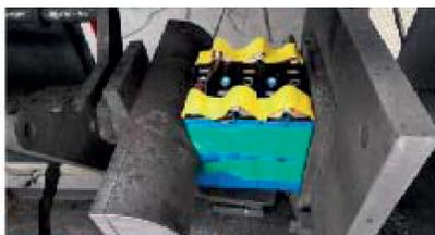
Испытание на экструзию
